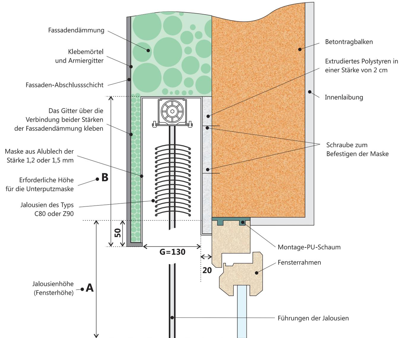
Mit integriertem Fliegengitter, ohne Fensterverbreiterung mit zusätzlicher Dämmung
